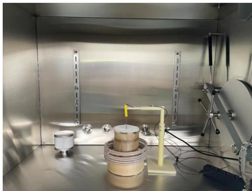
SP-15AB-GB 是一款可放入手套箱操作的感应加热炉，它通过电磁感应加热，能够快速达到实验所要求的温度（图片仅供参考，以最终实物为准）
