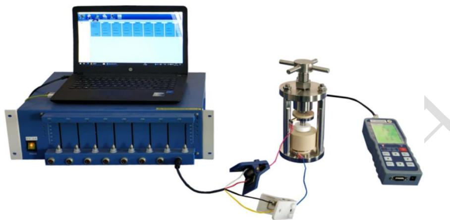
固态电池模具手动加压装置是一款可拆卸式电池测量装置，此款产品的模套采用具有高机械强度和抗腐蚀性的 PEEK 材料制作，操作简单，它可与小型加压装置配合使用，此款产品设计用于研究固态电池在不同压力影响下的电池材料性能。
