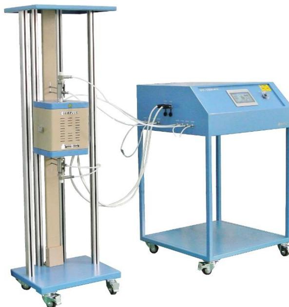
微型燃料电池（20mm）测试系统主要用于纽扣型电池的电化学测试分析，该仪器实现了电池的双室密封，可向电池阴阳两极定量通入不同的气体，且气密性良好，满足电池在 SOEC 和 SOFC 不同模式、不同气氛下的精密测试。仪器上下设置两个压紧弹簧，实现上下加压设计，可以确保铂网和电极、铂网和铂引线之间牢固连接。通过引线可以外接电化学工作站等其它测试设备。
