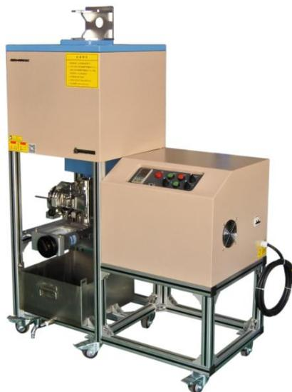
GSL-1700X-VTQ 是一款通过 UL 认证的立式真空管式淬火炉，标配直径 60mm 的刚玉管和一个用于样品淬火的液体密封容器。该设备实验时可以使样品从高温环境下（最高温度 1700℃）快速落入冰水或油中，非常使用以研究材料相变和微结构性能。
