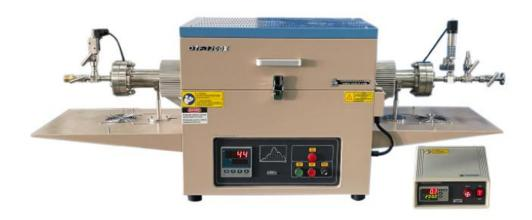
OTF-1200X-HP-60 是一款小型的高温高压管式炉,其炉管法兰上安装有高压电磁阀和压力传感器。所以当炉管内气压高于设定值时,电磁阀会自动打开排气,使炉管内气压达到设定值。炉管采用高温合金钢管制成,尺寸为外径 60\*内径 40\*长度 1000mm。此款设备可在高压氧环或惰性气体环境下对样品进行热处理,最高温度可达 1100℃
