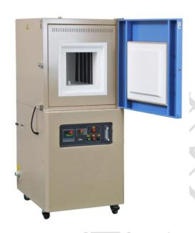
KSL-1700X-A4 是一款高温箱式炉,以硅钼棒为加热元件,采用双层壳体结构和 PID 程序控温,B 型热电偶,炉膛采用高纯氧化铝纤维材料,最高温度能达到 1700 度,可连续工作温度 1600 度,控温精度±1 度,该炉具有温场均匀、表面温度低,节能等优点,是高校、科研院所、工矿企业做高温烧结,金属退火、质量检测用的理想产品。
