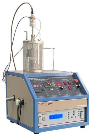
VTC-2RF 小型台式单靶等离子溅射仪，配有一个 2 英寸的磁控等离子溅射头和射频等离子电源。一个可加热的旋转样品台，长期使用温度为 500℃，样品台与靶材之间的高度可调节。此款设备主要用于制作非导电薄膜，特别是一些氧化物薄膜。对于新型非导电薄膜的探索，它是一款性价比高并且高效的实验帮手。如果客户需要制作金属薄膜，我们也可以配置高压直流电源，适合客户制作一些金属薄膜。
