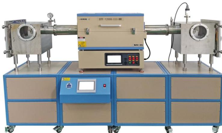
OTF-1200X-III-RR 是一款卷对卷材料制备系统，本系统包含三温区管式炉，卷对卷装置以及供气系统。管式炉以电阻丝为加热元件，采用双层壳体结构和 30 段程序控温，K 型热电偶，炉膛采用高纯氧化铝纤维材料，卷对卷材料在高温炉中移动速度可调。
