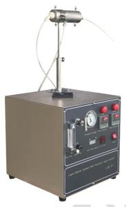
LVD-F1 是一款专门针对实验室中 CVD 实验中导入液体的一套系统,其液体流量是通过一数字液体泵来控制,最小流量控制在 0.007ml/min。液体被数字泵导入到混气系统后,被系统里的加热装置加热成蒸汽,然后随导入的气体被带入到炉管中。LVD-F1 能够导出多种液体,比如 ETOH, SnC14, TiC14r, SiHC13, 和 Zn(C2H5)2,还有多种有机物混合。对于研究用 CVD 方法生长纳米线和薄膜 LVD-F1 是一款极佳的研究工具。
