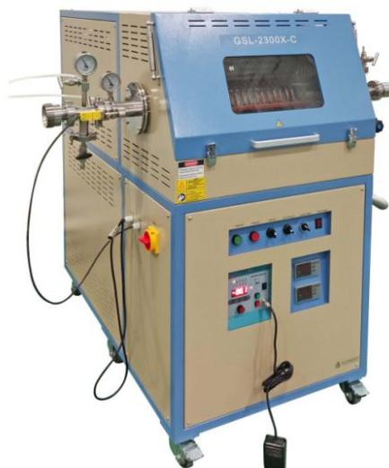
GSL-2300X-C 是一款感应加热的卧式管式炉，最高温度可达 2300℃，可以在真空和气氛保护下使用。可以在内部放置一根  $\phi 26\text{mm}$  的刚玉管（最高耐温 1700℃），用于在空气、水蒸气或氧气气氛下使用。
