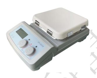
SP-H550 是一款通过 CE 认证的热偶外置式加热型磁力搅拌器,通过 LCD 屏可设置和显示转速、温度。配有外置温度传感器 PT1000,可实时反馈样品实际温度。此款设备最高加热温度可达到 550℃。本仪器是为学校、实验室和工厂等应用环境设计的,用于对液体进行加热及搅拌。
