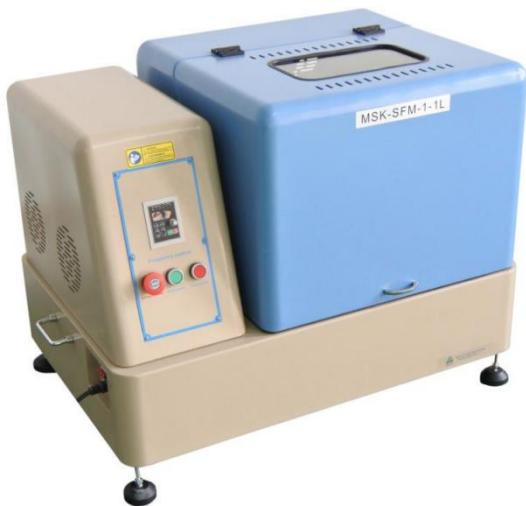
SFM-1-1L 是一款行星球磨机，转盘上可装 4 个混料罐，每个混料罐的容积为 1L，当转盘转动时，混料罐中心轴作行星运动，罐中磨球在高速运动中研磨和混和样品。该产品能用干、湿两种方法粉碎和混和粒度不同，材料各异的产品，研磨产品最小粒度可至即 (1.0×10<sup>-4</sup>mm)。广泛应用于地质、矿产、冶金、电子、建材、陶瓷、化工、轻工、医药、环保等部门。
