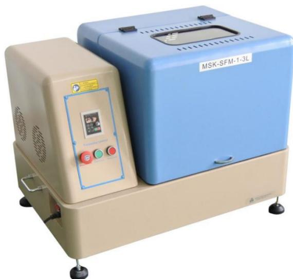
SFM-1-3L 是一款行星式球磨机，转盘上可装 4 个混料罐，每个混料罐的容积为 3L，当转盘转动时，混料罐中心轴作行星运动，罐中磨球在高速运动中研磨和混和样品。该产品能用干、湿两种方法粉碎和混和粒度不同，材料各异的产品，研磨产品最小粒度可至即（ $1.0 \times 10^{-4}$ mm）。广泛应用于地质、矿产、冶金、电子、建材、陶瓷、化工、轻工、医药、环保等部门。
