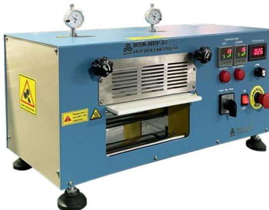
MSK-HRP-04 是一款小型立式加热辊压机，两个轧辊的温度由两块温控仪表独立控制，最高加热温度为 200℃，此款轧机设计可以用于制作柔性电池电极，隔膜，固态电池的电解质等。（警告：不可辊扎硬度 RC>45 的材料）。
