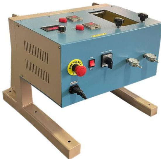
MSK-HRP-02 是一款小型立式加热辊压机，两个轧辊的温度由两块温控仪表独立控制，最高加热温度为 200℃，由于立体设计，所以允许“自重进料”来制作柔性薄膜。所以可用于制作 Li-S,Na 离子或各种金属空气电池的电极
