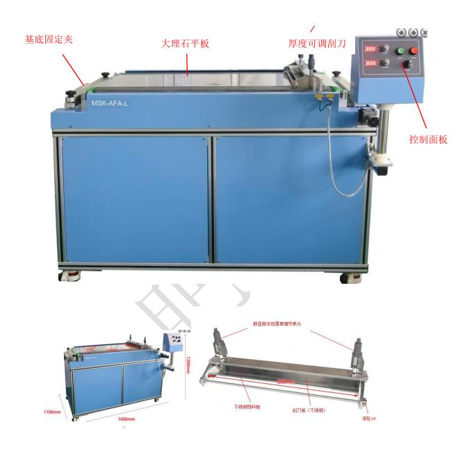
MSK-AFA-L500 是一款大型的平板涂布机,最大涂布面积为500mmW×920mmL。一天数显千分标头来调节刮刀板与基底的间隙,最大间隙5mm,调节精度1um。一个推杆推动刮刀移动达到平滑和均匀地涂布。
