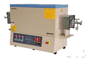
GSL-1700X-Ⅲ 是一款 CE 认证的三温区高温管式炉,其炉管外径为 60mm,三个数字温度控制器可独立控制温度,并可设置 30 段升降温程序,温区 1(加热区中心)采用硅钼棒进行加热,最高温度可达到 1700℃时,另外两个温区用硅碳棒进行加热,最高温度可达到 1400℃时,此款管式炉可以形成一个温度梯度,调整三个温区的温度,在热梯度下制备功能材料,他是一款理想的设备,同时也适用于 CVD 法制作薄膜外延生长。
