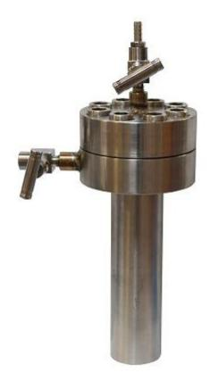
RC-Ni-V 是一款小型水热反应器,采用镍基合金钢制作,有极好的蠕变强度和抗氧化性。反应器能达到 4MPa(O2 或惰性气体),可承受温度 1100℃。此款产品特别适合使用水热法来制备先进材料,特别适合需要在高压氧环境下处理的样品。
