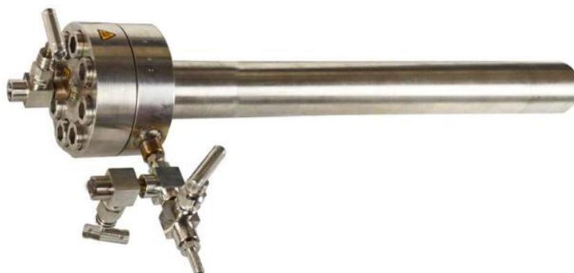
镍基高温合金钢管（外径 55×内径 20×长度 580mm）。可高氧化性，惰性和还原性气体，最高温度可达 1100℃。此炉管为本公司高温高压管式炉 OTF-1200X-HP-55 的炉管。
