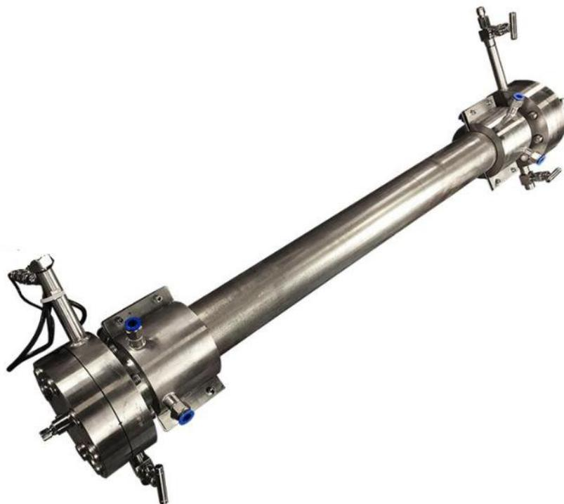
镍基高温合金钢管（外径 100×内径 82×长度 1200mm）。可高氧化性，惰性和还原性气体，最高温度可达 1100℃。此炉管为本公司高温高压管式炉 OTF-1200X-HP-III 的炉管。
