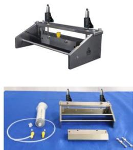
混合式制膜器包含 2 个部分，挤压头为 PEEK 材质，刮刀为不锈钢材质
