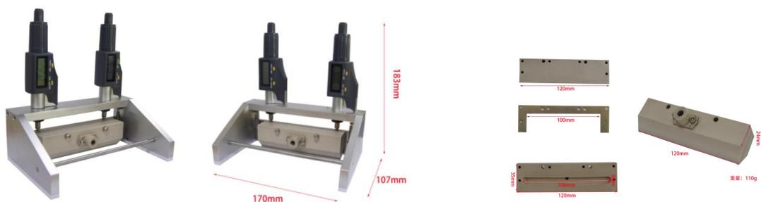
HDS-150PEEK 是一款混合制膜器，挤压式涂布（slot die）制备薄膜，挤压头采用 peek 材料制做，适用于一些不可接触金属的浆料。可用于刮刀式涂布（流延涂布）制备后膜，。此产品是一款非常好的实验室制膜设备，可用于制作电池极片，铅钛矿太阳能电池薄膜和燃料电池膜等。
