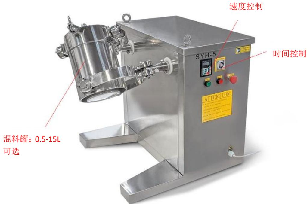
SYH-5 是一款三维摆动混料机，主要设计用于干粉混合。粉体在混料罐中三维运动，大破离心力和重量造成的粉料堆积，达到不同粉末均匀混合的效果。此款混料机特别适合混合密度差别比较大的粉体材料。混料罐材质为 304 不锈钢，标配一个 5L 混料罐，可选 0.5L-15L 混料罐。
