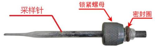
左端安装上预留有一个 1/16 英寸的铠装热电偶接口，可以实时测量石英内腔体的实际反应温度。
