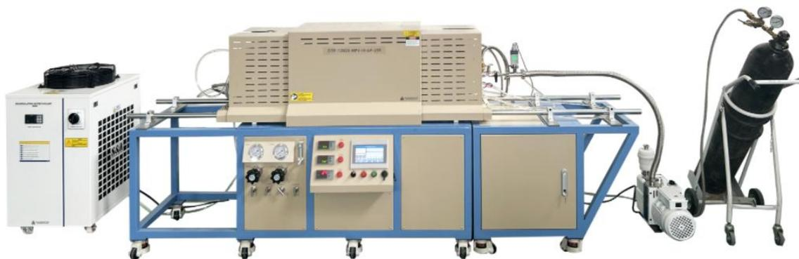
OTF-1200X-HPV-III-GF-200 高温高压炉是一款内加热的三温区高温高压炉，炉子可承受的最高温度为 1100℃（在此温度下可承受的压力为 10MPa）。此款设备可用于超临界水热燃烧研究，也特别适合在高压氧环境下对样品进行热处理，是专门为氧化物超导线和氧化物陶瓷进行热处理而设计。
