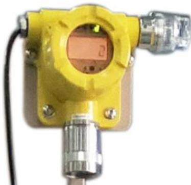
该气体探测器采用催化燃烧式原理，利用加热元件测量可燃气体在传感器表面燃烧反应放出的热量的原理，即燃烧使铂丝线圈的温度升高，线圈的电阻值上升。测量铂丝电阻值变的大小就可以知道可燃气体的浓度大小（图片仅供参考，请以实物为准）
