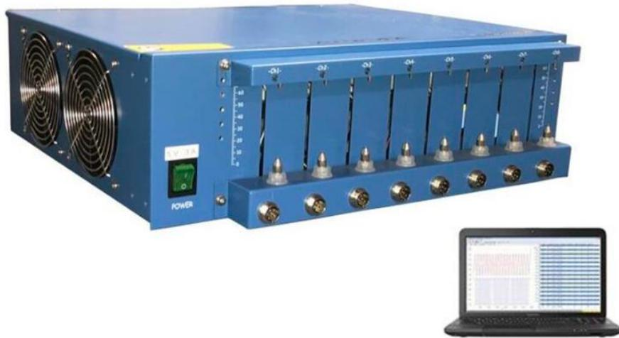
BST8-1A 是一款 8 通道电池测试仪，用于测试分析小扣式电池，柱状电池和软包电池，电流范围 2mA-1000mA。每一个通道都有独立的恒压恒流源，可通过电脑编程软件控制。此款设备广泛应用于电极材料研究，电池性能测试等。
