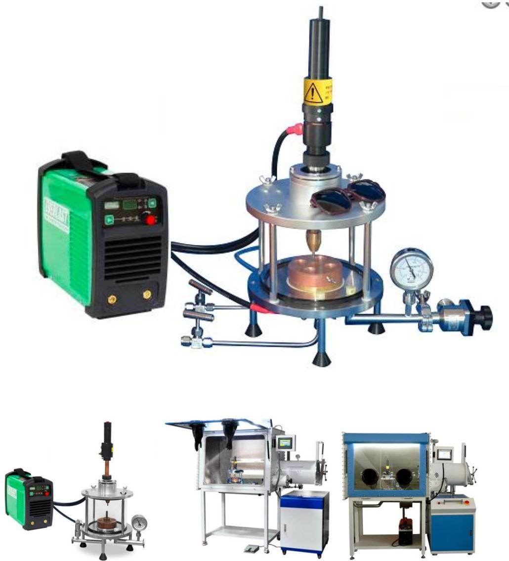
SP-MSM130 是一款微型电弧熔炼炉，可放在手套箱内熔炼一些空气敏感性材料。这是一款小巧的熔炼工具，可熔炼合金，可把材料密封在难熔金属管内，和真空吸铸功能。增加一些配件后，也可在手套箱外熔炼材料。
