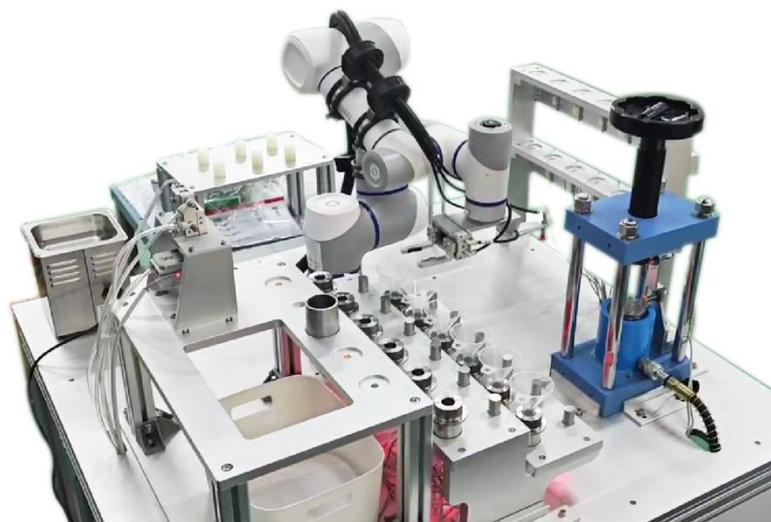
YLJ-24T-PE 是一款程控型电动压片机,最大压力可达 24T,可用于制备陶瓷或粉末冶金等样品。电动油泵与压机主动分开,便于设备维修和更换。此设备可一次性自动压制 12 份样品。
