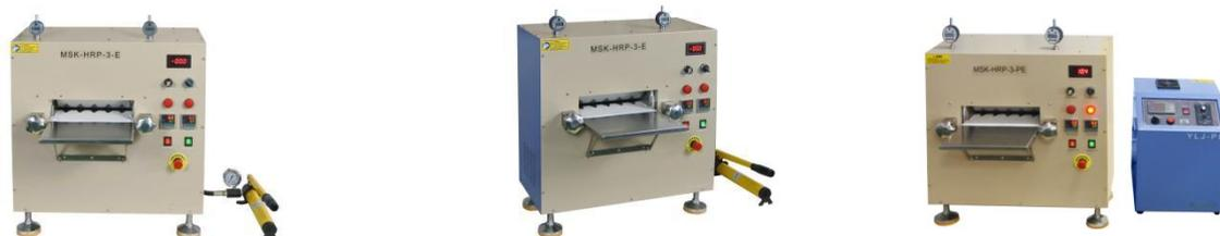
MSK-HRP-3-E 是一款可前置调节压力的加热型辊轧机，最大压力可达 10T，两个轧辊都有独立的温控仪表控制温度，最高温度可达 150℃。此款轧机用于电池极片轧制压延，也用于多层极片的复合
