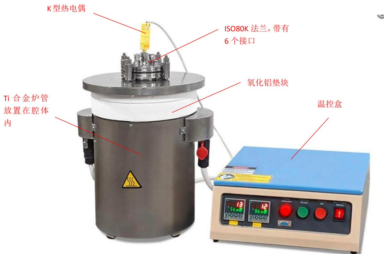
VBF-600Ti 是一款小型的立式管式炉，放置有钛合金反应釜。此设备设计用于熔盐电解和熔盐电池的研究。反应釜顶部法兰上有 6 个 1/4 英寸接口，可用于通入气体和出气，电极引线和插入热电偶测温。
