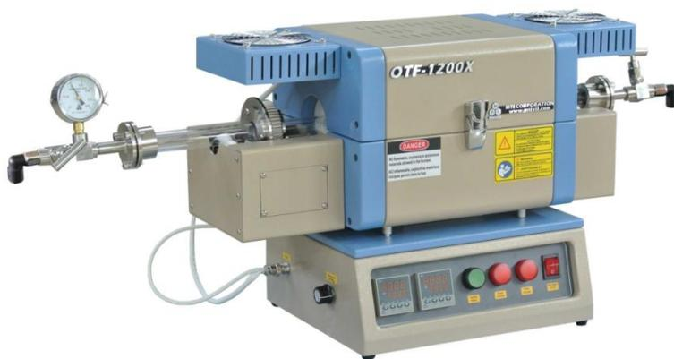
OTF-1200X-S-R-II 是一款小型双温区回转炉，此款回转炉设计主要是为了烧结粉体材料更加均匀，特别适合用于锂离子电池阴极材料包裹一层导电层（采用 CVD 方式）
