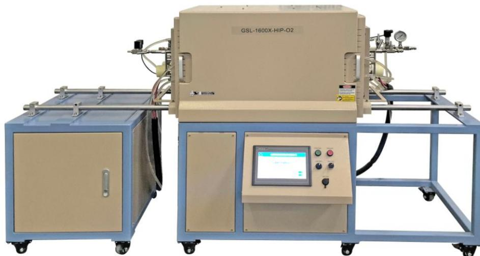
GSL-1600X-HIP-O2 高温高压氧气管式炉，采用硅钼棒加热，可在空气、氧气气氛或 N<sub>2</sub>、Ar 惰性气氛下使用。法兰两端带有石英观察窗口，实现原位观察物料高温高压下的状态，此设备常压下最高加热温度可达 1700℃，腔体最高承受压力可达 10 MPa（不带观察窗口）。此款设备适合在高压氧环境下对样品进行热处理，也是特意为氧化物超导线和氧化物陶瓷进行热处理而设计。
