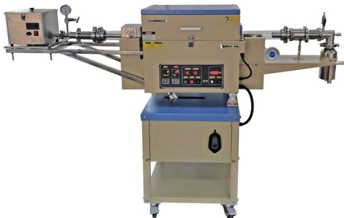
OTF-1200X-4-R-II-AF 是一款双温区回转管式炉，安装有自动送料器和收料罐。自动可定份额地将粉料送入到炉管中，此过程可在气氛保护环境下进行，可实现用连续 CVD 方法对粉体材料进行包覆和修饰。收料罐可在气氛保护环境下对处理好的粉料进行收集。此款管式炉设计主要是在锂离子电池的阴极材料（如  $\text{LiFePO}_3$ ,  $\text{LiMnNiO}_3$ ）上包覆导电层，同时也可用 CVD 方式制备 Si/C 阳极材料。
