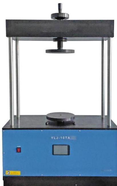
YLJ-10TA 电动无油压力机是一套由可编程触摸屏控制界面、大扭矩步进电机以及承压系统组成的压力实验设备，拥有操作简易、强大稳定、控制精准等特点，便于客户进行实验操作。
