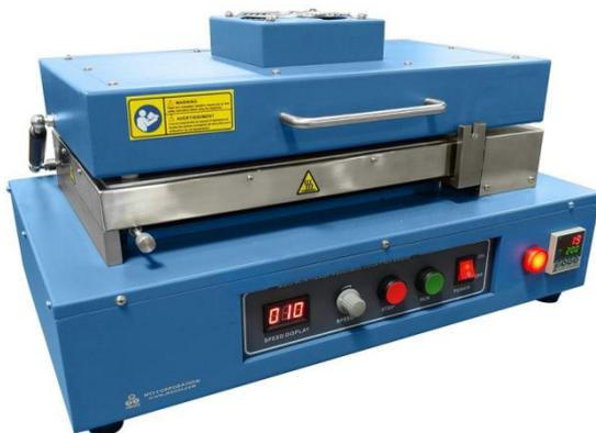
MSK-AFA-H200A 是一款底部加热的小型涂覆机，其最高温度可达 200℃，采用真空吸附来固定基底，顶部安装有活性炭过滤系统，可以保护实验室环境。此款设备特别适合高温涂覆聚合物膜和导电陶瓷膜。
