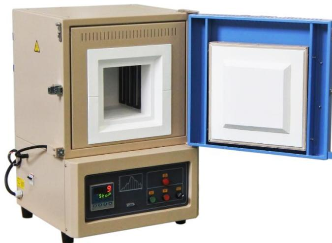
KSL-1700X-A3 是一款高温箱式炉，以硅钼棒为加热元件，采用双层壳体结构和 PID 程序控温，B 型热电偶，炉膛采用高纯氧化铝纤维材料，最高温度能达到 1700 度，可连续工作温度为 1600 度，控温精度  $\pm 1$  度。该炉具有温场均匀、表面温度低，节能等优点，是高校、科研院所、工矿企业做高温烧结，金属退火、质量检测用的理想产品。
